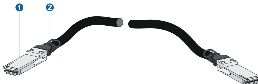
图6-3 QSFP+电缆外观示意图
