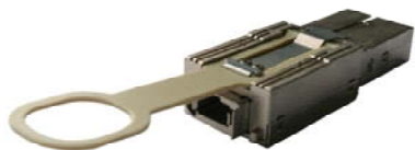
图9-1 CXP 光模块外观示意图
